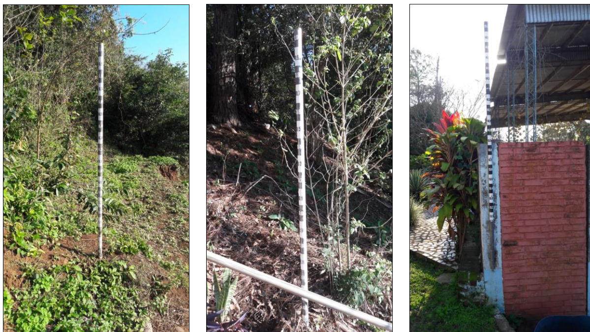
Figura 22: Régua utilizada para controle do nível de água do rio Uruguai, instalada em pontos da margem deste.
