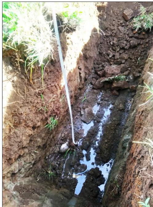
Figura 10: Afloramento do nível freático na vala 01.
